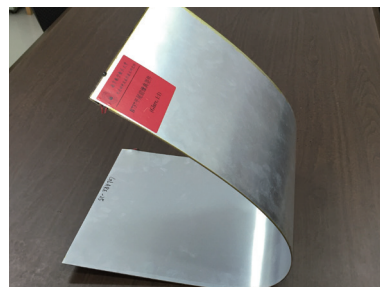
图4 NFMLs自成形构件实物
